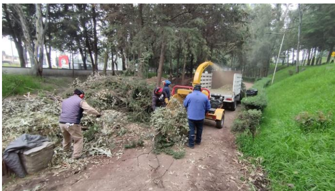
Ilustración 2.- Proceso de trituración de ramas para su integración en el proceso de compostaje.
